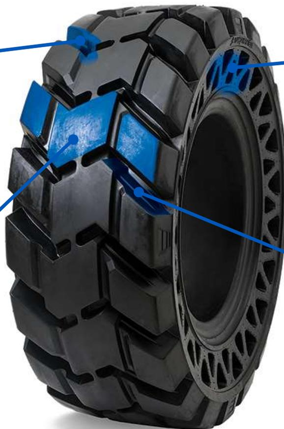
**Конструкция боковины с отверстиями треугольной формы**
